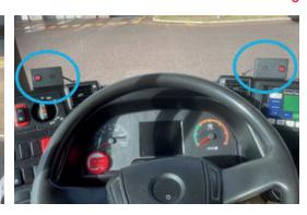
Installation d'un dispositif de détection des usagers vulnérables
