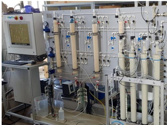
Figure 98 : Pilote d'extraction direct de lithium déployé sur la centrale géothermique d'Insheim. Un modèle de taille « laboratoire » permet également de réaliser des tests sur tous types de saumures telles que celles qui seront recueillies après le premier forage dans le périmètre sollicité.
