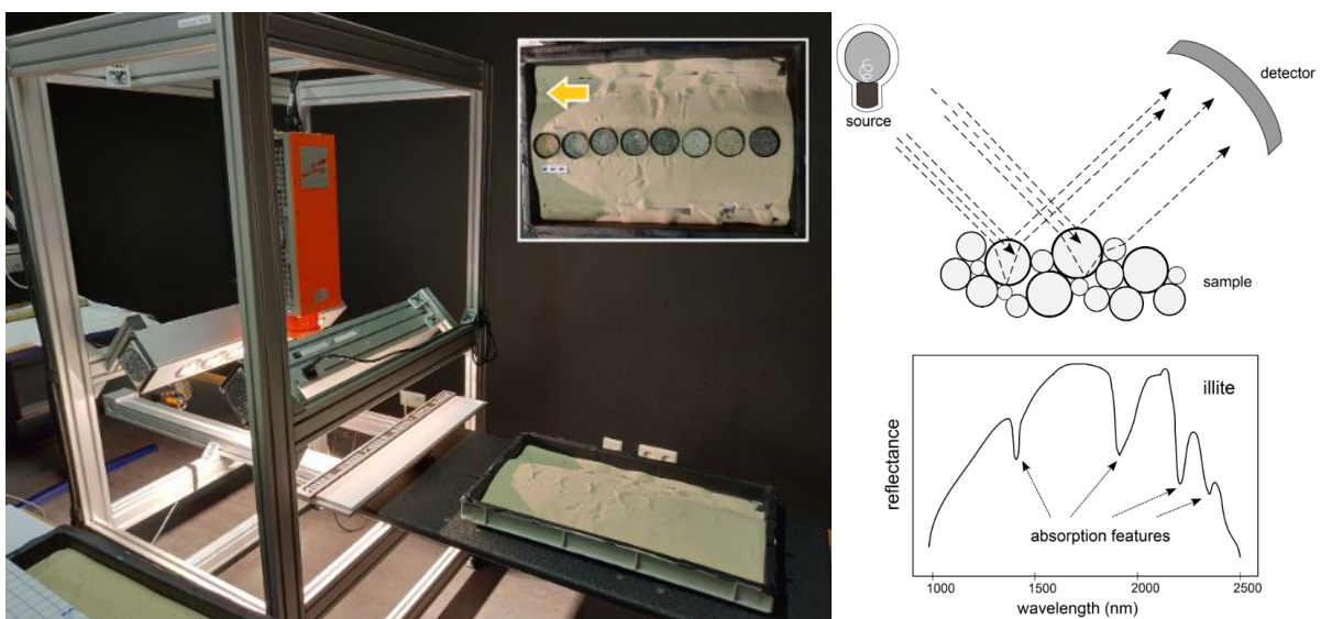
Figure 93 : (à gauche) Caméra spectrale Specim SWIR 3 et (à droite) schéma du fonctionnement. (Source : (Savitri et al. 2021))
