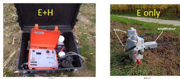
Figure 2 : Exemple d'équipements pour une campagne CSEM, à gauche une stations MT et à droite une station CSEM. (Source : (Darnet et al. 2021))
