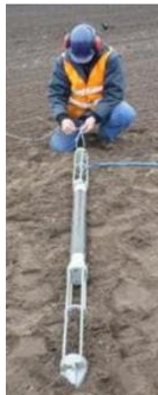
Figure 67 : Mise en œuvre au Canada et en Hollande, ces sources sismiques enterrées ont permis le suivi de réservoir pétrolier en 4D et se trouve être des sources d'ondes S. (Source : (Cotton, 2019))
