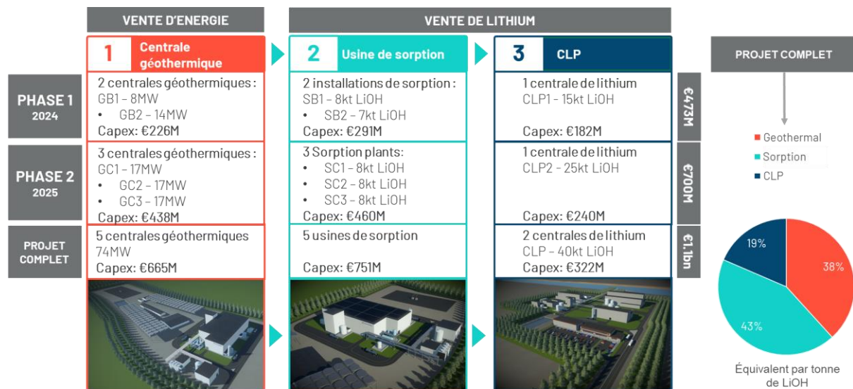
Figure 7 : Description des phases et des coûts de développement prévus pour le projet Outre-Rhin de Vulcan Energie Ressourcen GmbH.
